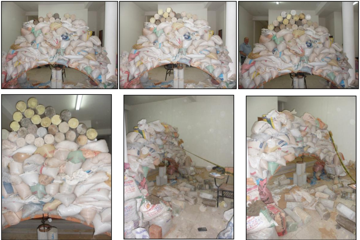
Gráficos: Proceso de cargas de probetas hasta su caída por desequilibrio. Fuente: Imágenes de elaboración propia.
