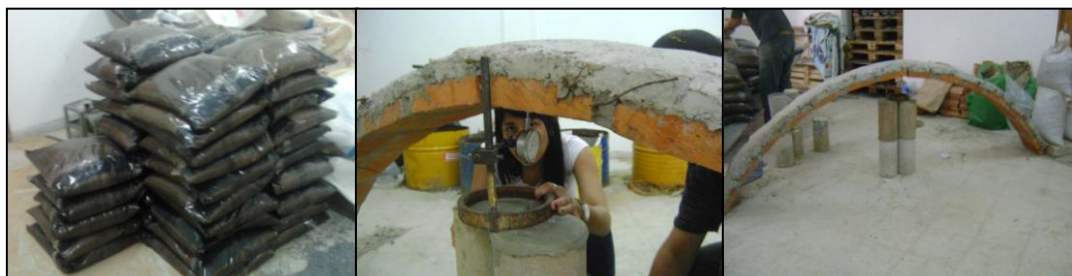
Gráficos de Cargas en panes y Proceso de colocación de arco y deflectometro.
